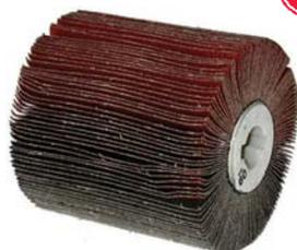
Con foro d'attacco Ø mm 19,1 e sede per chiavetta. Adatte per le più diffuse smerigliatrici, lucidatrici e satinatrici. Con lamelle in corindone. Per levigare, sbavare, pulire acciai, ghise, fusioni, legni ecc. Dimensioni mm 100x100. Velocità massima 6800 giri/min.
