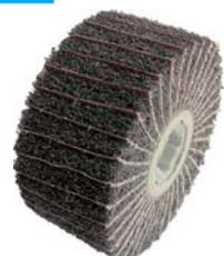
Con foro d'attacco Ø mm 19,1 e sede per chiavetta. Adatte per le più diffuse smerigliatrici, lucidatrici e satinatrici. In materiale fibroso combinato con lamelle in corindone. Per smerigliare, levigare e lucidare leghe al Cromo Nickel, leghe leggere, metalli dolci, legni ecc. Dimensioni mm 100x50. Velocità massima 6800 giri/min.
