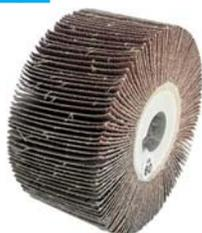
Con foro d'attacco Ø mm 19,1 e sede per chiavetta. Adatte per le più diffuse smerigliatrici, lucidatrici e satinatrici. Con lamelle in corindone. Per levigare, sbavare, pulire acciai, ghise, fusioni, legni ecc. Dimensioni mm 100x50. Velocità massima 6800 giri/min.
